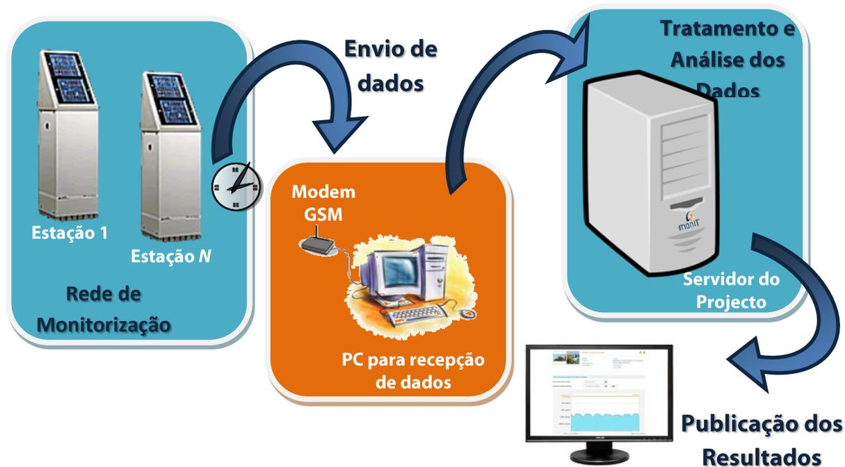
Figura 2 – Processo de monitorização contínua.
